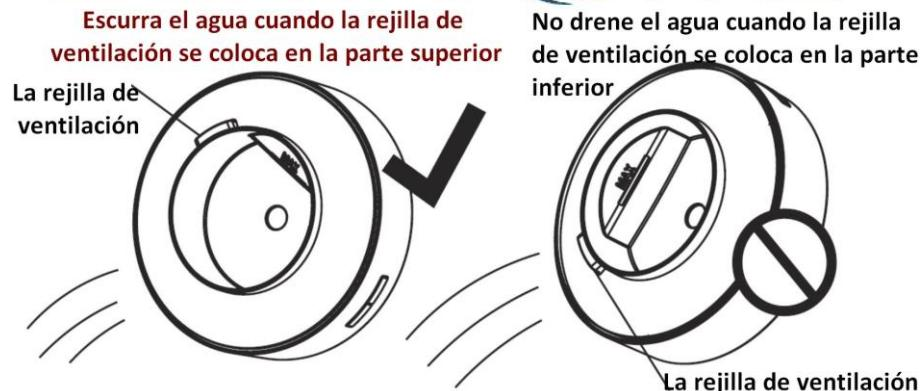
**Atención:** Nunca agregue agua o está húmedo o bloquear la rejilla de ventilación (soplador). Los botones del aparato no son resistentes al agua y no deben entrar en contacto con el agua. No sumerja la emisora.
